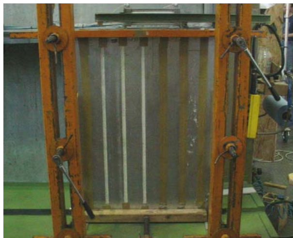
Abbildung 1 Geschäumte Fugen in Prüfvorrichtung für Längsfugen nach DIN 18542, aufgebaut auf dem Fensterprüfstand
